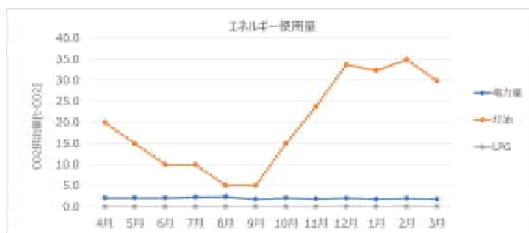
図 1-1-7 温水プール・原谷公民館の月別のエネルギー使用量変化
